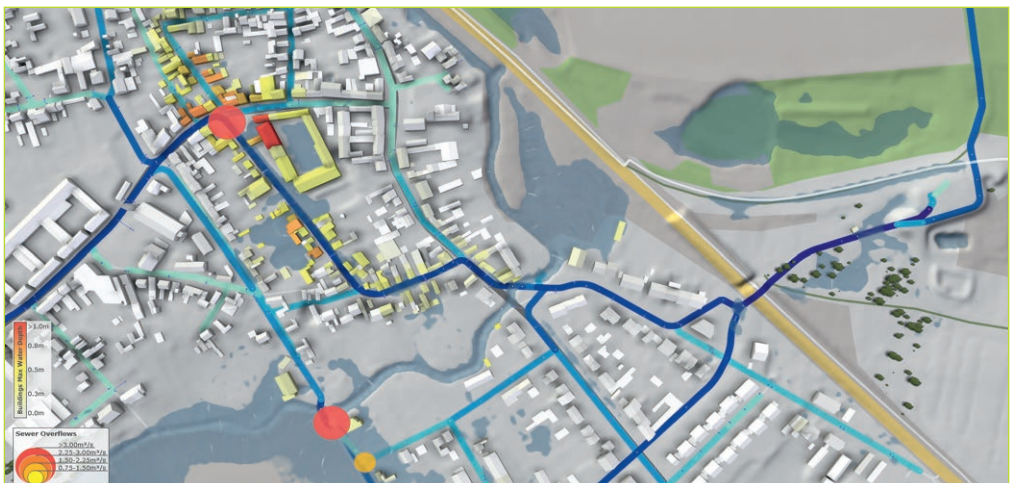
Starkregensimulation mit Kanalnetzkopplung.
